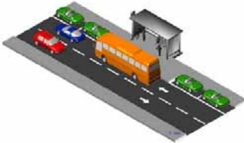
*Ce type d'arrêt est caractérisé par la construction d'une avancée de trottoir d'une longueur équivalente à celle des bus qui fréquentent l'arrêt : 13m pour un bus standard, 18 m pour un bus articulé et de 25m pour un véhicule long.*
