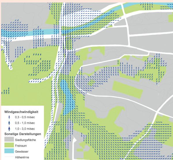
**Abb. 6.3** Optimierung der Durchlüftung durch Gebäudestellung – Beispiel aus Karlsruhe<sup>5</sup>
