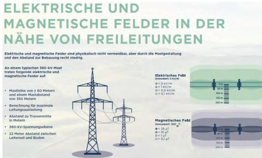
Abbildung 2: Wirkungsbereich und Stärke von elektrischen und magnetischen Feldern (hier ein Beispiel einer 380 kV-Leitung).
