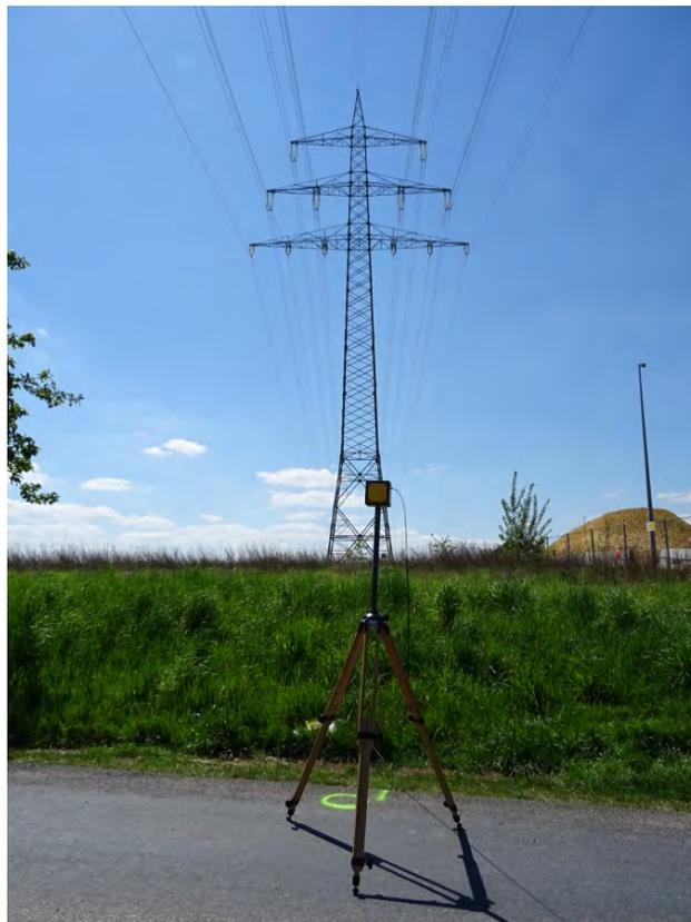
Abb. 8: Messung des elektrischen Feldes (hier am Referenzpunkt in Trassenmitte)
