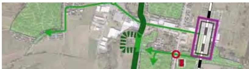
Abbildung 54: direkte Verbindung der PC 15 über die rue Toni Erpelding in Walfer (hellgrün: neue Strecke der PC 15, dunkelgrün strichliert ersetzte Strecke PC 15, dunkelgrün: Bestand PC 15)
